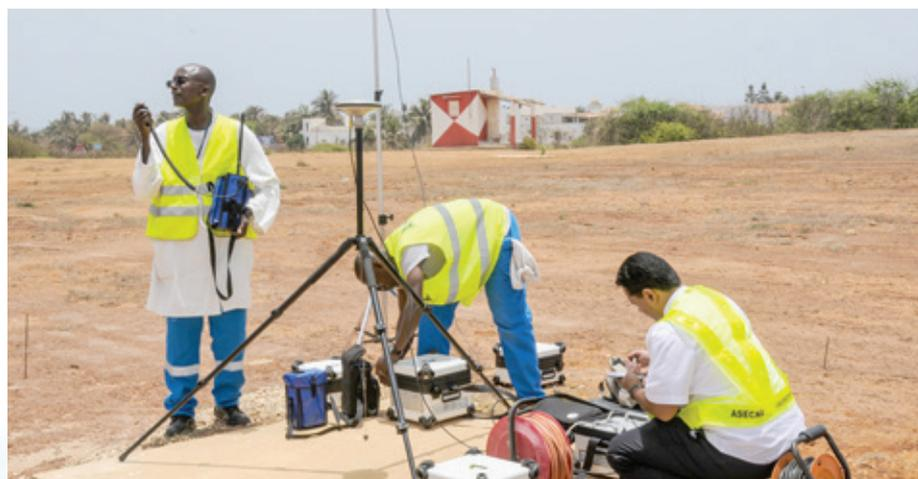
Le Banc numérique a de nombreuses capacités, comme les calculs en temps réel, l'archivage des données en temps réel, les utilisations multiples, une meilleure qualité des mesures par le traitement numérique qui efface toutes les dérives de l'analogique (bruit, température, etc...). L'avion effectue des contrôles sur les ILS, les VOR ou DVOR, les DME, les PAPI/VASI, les NDB, les radars, les VHF/HF, les procédures conventionnelles et les procédures RNAV/GNSS.
